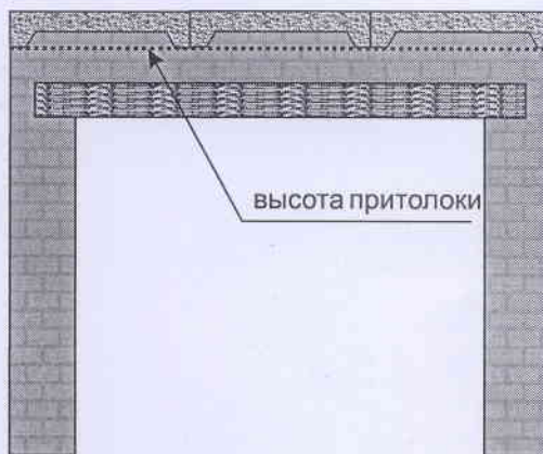
Рис. 12 Потолок из плит с ребрами жесткости
